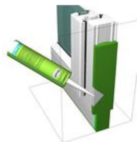
Ilustracja 2: Wypełnić wykrojone miejsce klejem tworząc klin.
