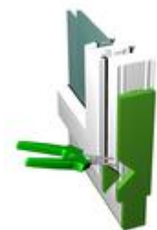
Ilustracja: W uszczelnieniu wyciąć miejsce na klin
